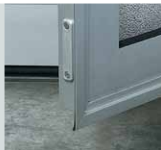
接触器单元 门中门接触器单元保证了只有在门中门关闭的状态下整樘大门才能运行。
