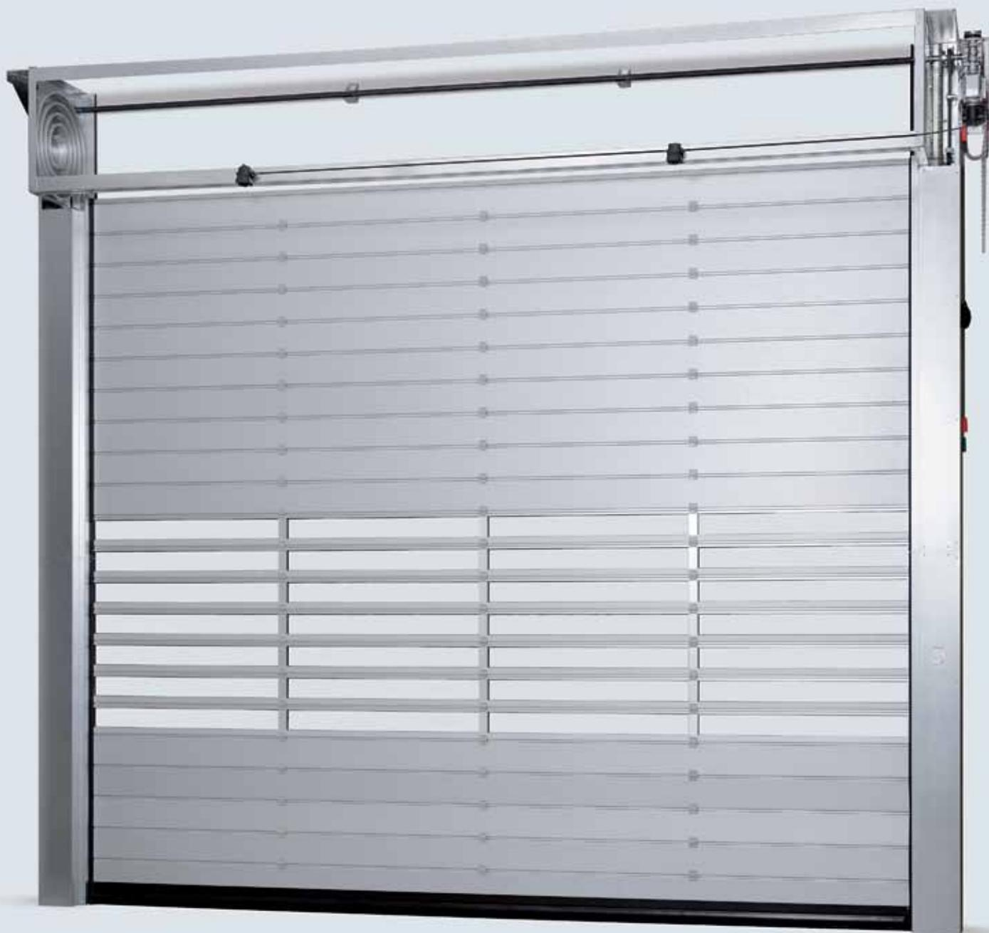
螺盘轨道快速门 HS 7030 PU 的最大特点是采用了双层热镀锌钢板制成的门板。表面为雅致的Micrograin细条纹，可以达到非常不错的保温效果。凭借先进的无接触式卷起技术和配备的光栅装置，该门能够达到很高的开启速度。
